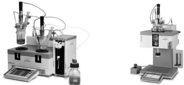
L'EasyMax™ (à gauche) et le tout nouveau système OptiMax™ (à droite), des stations de synthèse simples, robustes et compactes.
